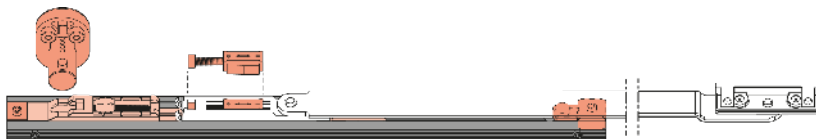
Abb.37: Einstellung Öffnungsbegrenzer mit Bremse, abschließbar Fig.37: Positions opening limiter with brake, lockable
